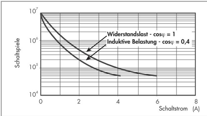
**H 32 - Gleichstromschaltvermögen bei DC1 - Belastung**
